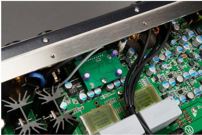
ZeroUno DAC MKII採用ECCOS D 晶片，以MO 自己撰寫韌體，加上重量級電源供應，可說是玩家級作法。D 晶片藏在圖中小電路板下方。
