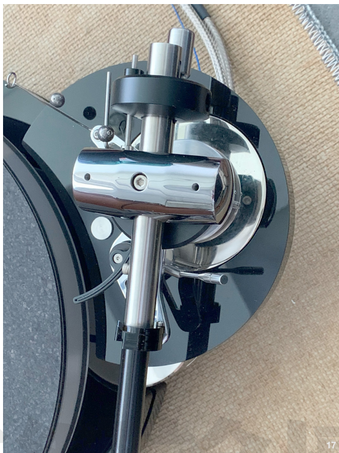
17. Enterprise MK4屬於雙軸心支點設計，支軸上那二個孔可以調整Azimuth，臂管以六種材料製成，十分複雜。
