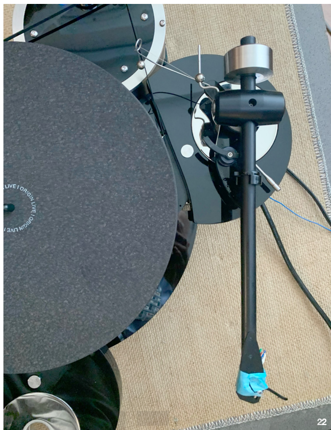
22. Onyx MK3屬於一般單軸心設計，平衡錘直接用手去轉，不過很緊，也是怕因為太鬆會晃動。抗滑方式一樣以釣魚線圓球為之。
