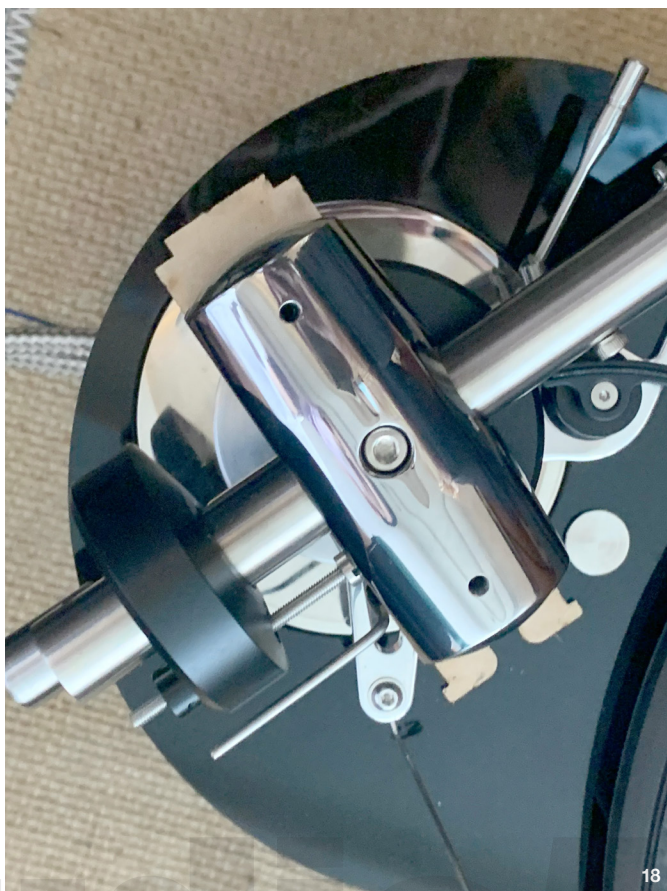
18. 由於唱臂支軸很精細，所以運送時要先塞一片襯片保護。
