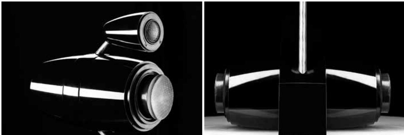
E2的高音單體振膜採用碳纖維，中音與低音單體振膜也是碳纖維，不過有凹、凸盆之分，單體中沒有彈波、沒有懸邊、振膜等於是裝在一個繞著線圈的套筒上做活塞運動，非常特殊。
